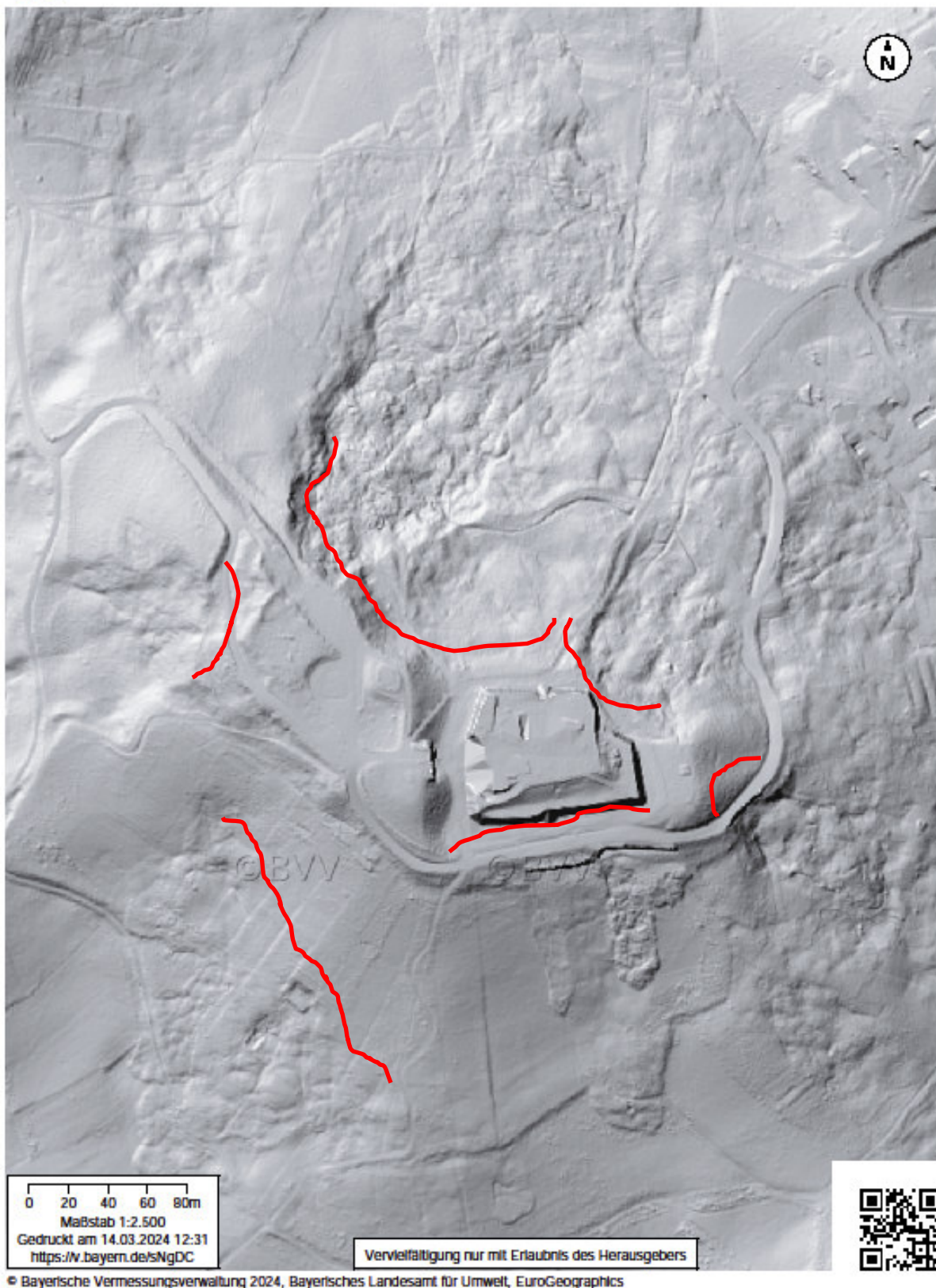
Abb. 2 Geländeerief im Umfeld der Altenburg mit eingezeichneten Hangrutschkanten
